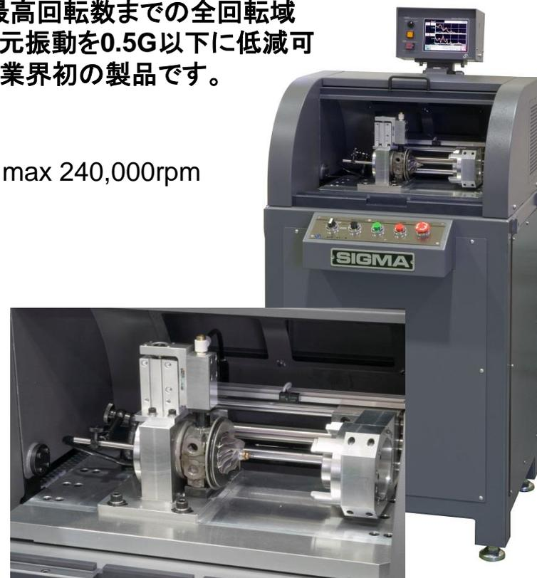
写真-3 ターボASSY専用釣合い試験機
