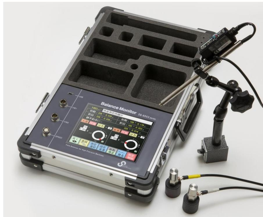
写真-2 一定速バランサー SB-8802R
